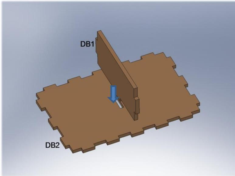
2. Aussenwände anbringen / Joining outer walls
